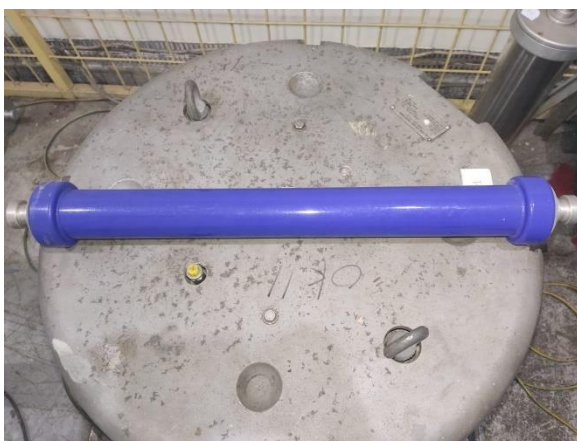
Isolator Tegangan Tinggi
