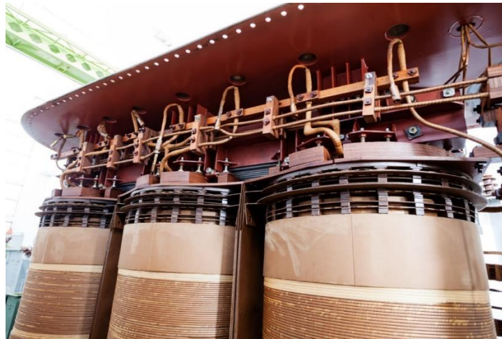
Gambar 30. Press Board berbahan dasar selulosa untuk insulasi transformator
